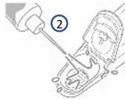
4. Couvrez le capteur complet avec une solution d'échantillon.
