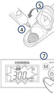
8. Appuyez sur **CAL** pour calibrer ou sur **MEAS** pour sélectionner l'autre point de calibration. Une fois le calibrage terminé, **CAL** et s'arrête de clignoter et la valeur mesurée s'affichée.
